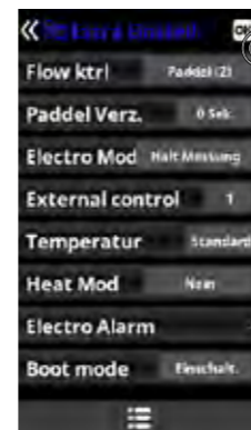
Den Menüpunkt Flow ktrl aufrufen und Paddel (2) wählen. Auf OK drücken, um die Auswahl zu bestätigen. In der Standardeinstellung ist die Steuereinheit auf Paddel oder Gas (3) eingestellt.
