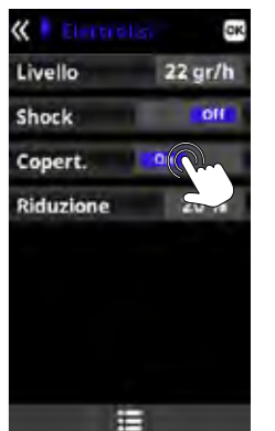
Copert.: Diminuzione della % di produzione di cloro quando la copertura è chiusa. Quando la copertura è chiusa, non è necessario che l'elettrolisi funzioni al 100%. Regolare la % di riduzione della produzione di cloro.
