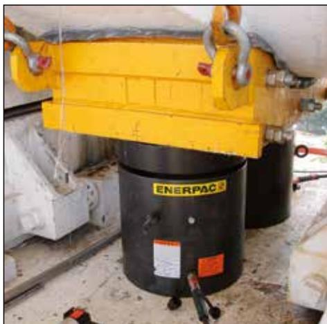
▲ Levage de charges lourdes et nivellement des fondations. L'écrou de sécurité assure un maintien mécanique sûr de la charge pendant une période prolongée.
