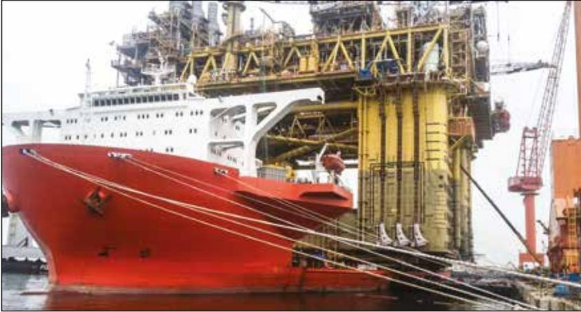
▲ Afin de procéder au super-levage et au lancement d'un système de production de pétrole flottant de pas moins de 43 000 tonnes en Malaisie, pour la plateforme offshore de Gumusut-Kakap, tout a été mis en œuvre pour privilégier la sécurité en utilisant des systèmes hydrauliques synchronisés EVO extrêmement sophistiqués dévolus au levage, à l'équilibrage, au pesage et à la pose tout en délicatesse d'importantes structures.
