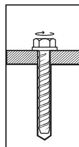
Visser la vis béton BETABOLT à travers la pièce à fixer, de préférence avec une visseuse/boulonneuse à chocs, en appliquant le couple de serrage  $t_{inst}$  suffisant.
