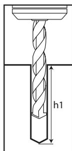
Percer un trou avec une perceuse à percussion à la profondeur recommandée  $h_1$ .
