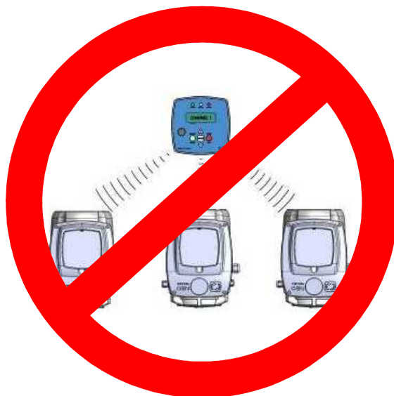
Picture 26: Communication impossible avec un seul clavier et plusieurs variateurs.
