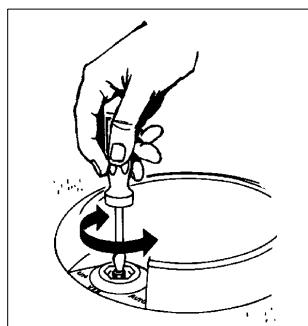
Les paramètres définis en usine sont signalés par un point bleu pour 70 psi (4,8 bar), un point blanc pour 80 psi (5,5 bar) et un point rouge pour 100 psi (6,9 bar).
