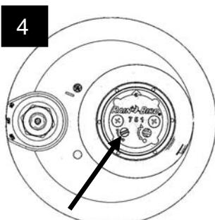
**HINWEIS:** Bei Regnern der Typenreihen 950/951 erfolgt die Einstellung des Sektors entgegengesetzt zu den übrigen Regnern (im Uhrzeigersinn zur Vergrößerung des Sektors und gegen den Uhrzeigersinn zur Verkleinerung des Sektors). Der Sektor kann von 40° bis 345° eingestellt werden. Beachten Sie die Pfeile auf dem Düsengehäuse.
