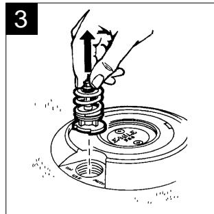
**REMARQUE :** si des débris sont venus se loger dans le système de régulation de pression, il faut pouvoir les rincer sans démonter l'ensemble. Desserrez légèrement le capuchon comme indiqué dans l'ÉTAPE 1 jusqu'à ce que l'eau commence à s'écouler du capuchon.
