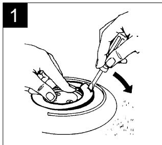
**HINWEIS:** Beim Entfernen des Sprengrings MÜSSEN Sie Druck auf das Düsengehäuse ausüben.
