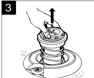
Nur bei älteren Modellen der Typenreihe 900 kann eine rote oder schwarze Dichtung in das Gehäuse fallen. Entfernen Sie sie einfach.
