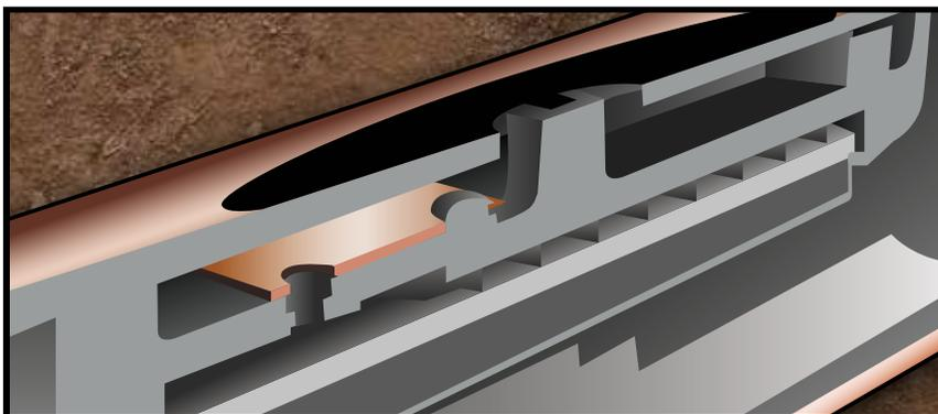
Les goutteurs XFS sont protégés de l'intrusion de racines grâce à la technologie Copper Shield de Rain Bird (brevet en instance). Ce système ne nécessite ni maintenance, ni remplacement de produits chimiques pour empêcher l'intrusion de racines. Sa couleur marron cuivré indique qu'il contient une lamelle de cuivre.
