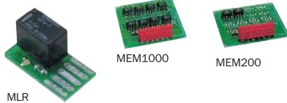
Receptor modular RXP dotado de display. Con la inserción de un módulo de memoria (MEM200, MEM200I, MEM1000, MEM1000I) el sistema aprende de 318 a 1000 códigos de emisores diferentes.
