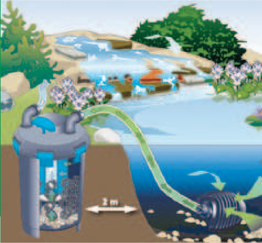
Représentation schématique : Filtre sous pression associé à une pompe pour filtre et ruisseau
