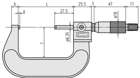
L: **30 mm**a: **2,5 mm**b: **5 mm**c: **26 mm**Ø d: **6,35 mm**
