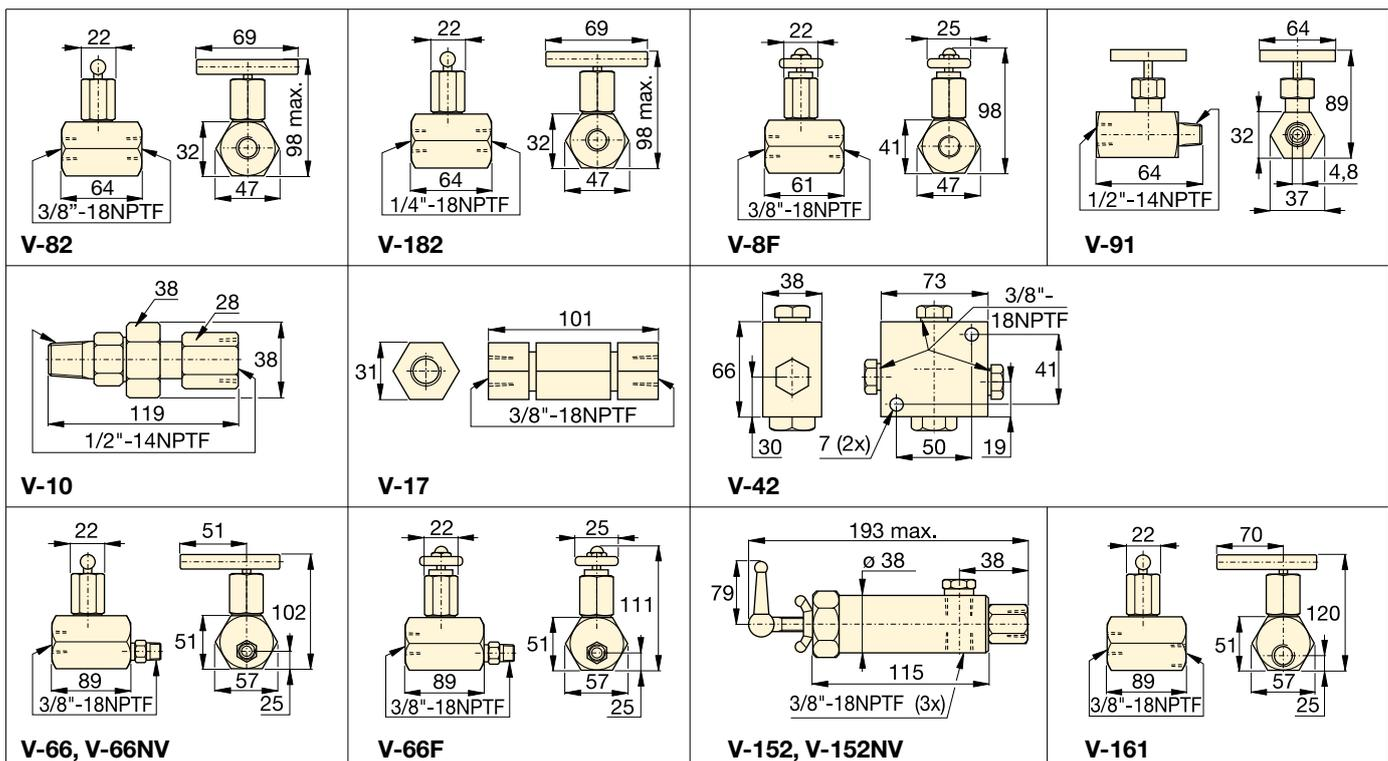
Dimensions des valves en millimètres.
