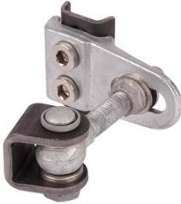
Charnière 180° galvanisé à chaud avec réglage en 4 dimensions. Profondeur, hauteur et l'espacement entre le poteau et le portail sont réglables après installation. Ce système breveté réduit vos stocks. Plus de portes gauches ou droites. Les pièces à souder sont disponibles en acier brut ou électrozingué.
