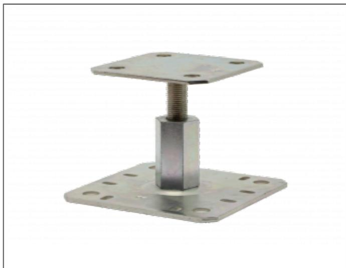
Les pieds de poteau APRN sont réglables en hauteur. Simples et rapides à installer, ils peuvent être réglés sur le chantier, l'écrou étant serti sur la platine basse, il est libre en rotation.
