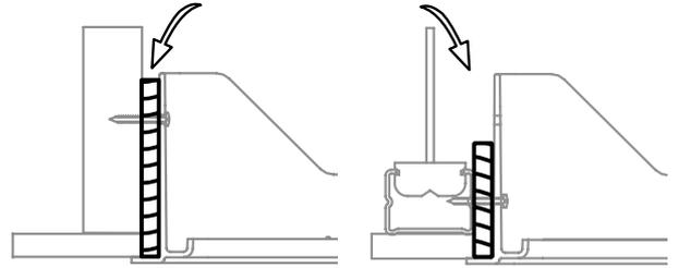
**1** Découper entre solives ou fermettes. Positionner la trappe à au moins 5 cm de tout mur ou cloison.
