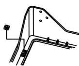
**1** Insérer l'écrou en force dans son logement.
