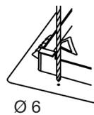
**2** Percer la trappe suivant l'avant trou. Ø 6
