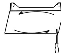
**3** Mettre en place la vis de verrouillage.
