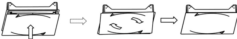
**4** Pousser la trappe (avec bord de la trappe et du cadre alignés) jusqu'à buter sur le cadre, la trappe pivote naturellement.
