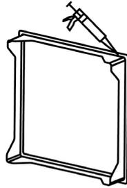
**Si besoin**, ajouter une cale au niveau des fixations pour combler l'espace entre le cadre et son logement.
