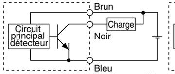
(lorsque la source d'alimentation est différente pour la charge et le détecteur).
