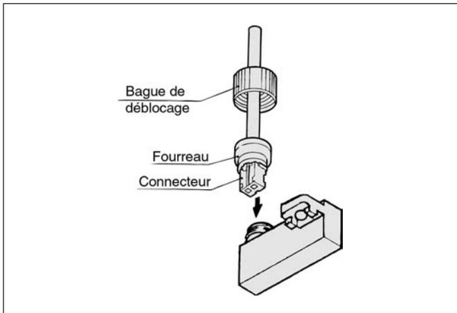
A l'aide de l'orifice convexe du connecteur, insérez le connecteur dans le fourreau du détecteur. Serrez la bague de blocage sur le détecteur. (N'utilisez pas de pinces)
