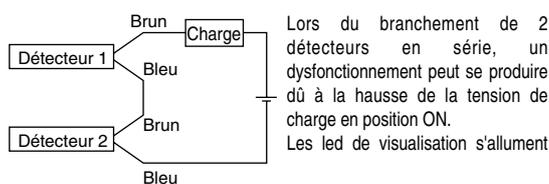
Lors du branchement de 2 détecteurs en série, un dysfonctionnement peut se produire dû à la hausse de la tension de charge en position ON. Les led de visualisation s'allument
