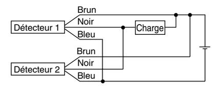
Les led de visualisation s'allument lorsque les deux détecteurs sont actionnés.
