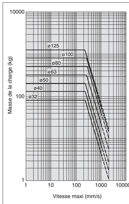
Exemple : Trouvez la limite de la charge maxi. applicable lorsqu'un vérin ø63 est utilisé à une vitesse maximum de 500 mm/s. Reportez 500 mm/s de l'axe des abscisses du graphique jusqu'au point d'intersection de la ligne pour l'alésage du tube de 63 mm, puis suivez ce point sur la gauche pour trouver la charge admissible de 80 kg.
