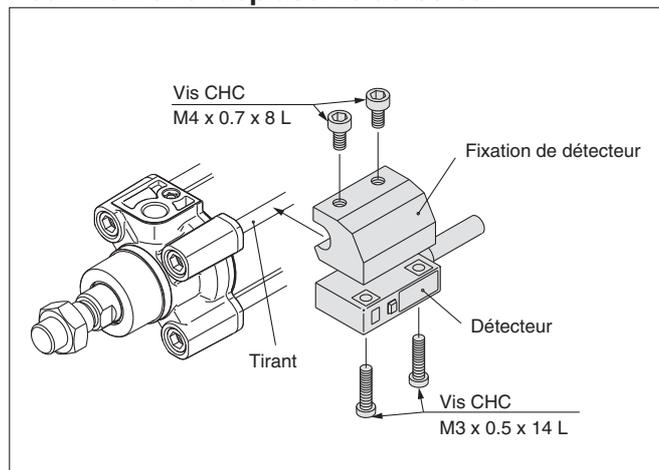
1. Vissez légèrement la vis CHC (M4 x 0.7 x 8 L) dans la partie taraudée M4 de la fixation de montage du détecteur. (2 positions) Faites attention à ce que l'extrémité de la vis ne dépasse pas la partie concave de la fixation de montage du détecteur.
