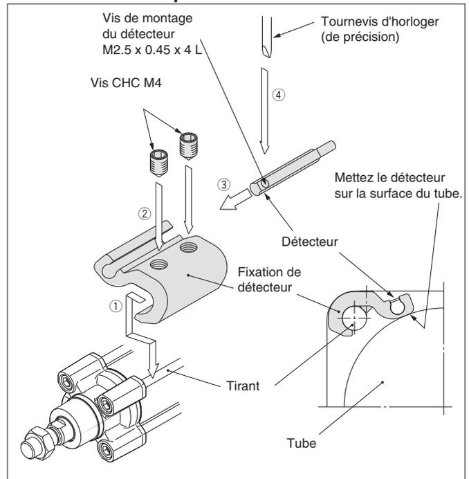
1. Fixez-le sur la position de détection avec une vis de blocage en installant une fixation de montage sur le tirant du vérin et en laissant la surface inférieure de la fixation en contact ferme avec le tube du vérin.
