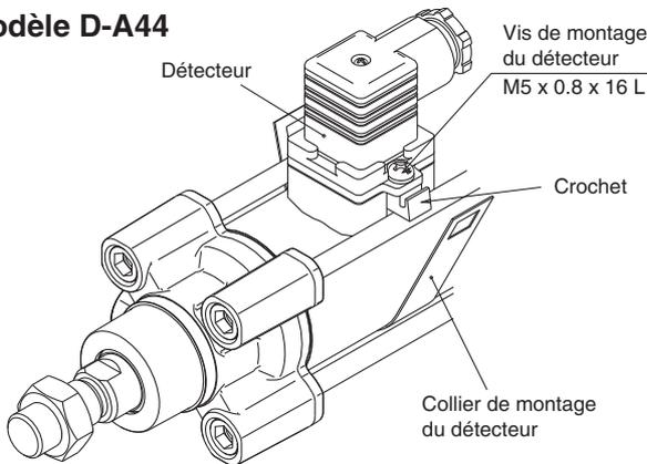
1. Desserrez les vis de montage du détecteur des deux côtés pour tirer le crochet vers le bas.
