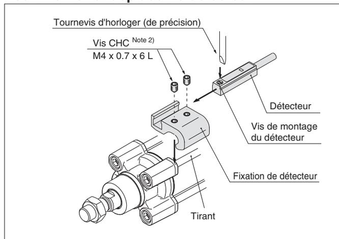
**Note 1) Utilisez un tournevis d'horloger de diamètre de manche de 5 à 6 mm pour serrer la vis de fixation du détecteur. Réglez la course de serrage entre 0.05 à 0.1 N-m. En guise de référence, tournez de 90° à partir de la position où la vis commence à être serrée. Réglez la course de serrage de la vis CHC (M4 x 0.7) entre 1.0 et 1.2 N-m.**
