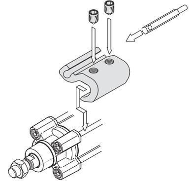
• Exemple de montage pour D-A9□(V), M9□(V), M9□W(V), M9□A(V)L
