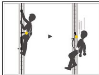
Lors de la progression verticale sur rail ou sur câble, le point d'attache LADDER CLIMB permet de connecter le chariot en position ventrale, ce qui répartit la tension sur la ceinture et assure ainsi un confort optimal. En cas de chute, ce point d'attache remonte automatiquement en position sternale pour assurer une position post-chute verticale du
