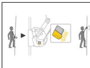
La fonction de blocage intégrée permet à l'utilisateur d'immobiliser l'appareil pour réduire la hauteur de chute.
