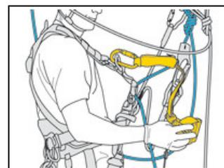
Le bras de connexion rendant le système imperdable au passage des fractionnements.
