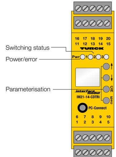
Le contrôleur de rotation IM21-14-CDTRI permet de surveiller les fréquences, les rotations et les trains d'impulsions, par exemple de parties de moteurs, d'entraînements et de turbines en mouvement et de contrôler alors la survitesse ou la sous-vitesse. Un afficheur à la face frontale de l'appareil indique la valeur actuelle.
