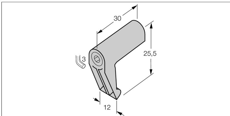
accessoires de montage pour détecteurs magnéto-inductifs pouvant être montés sur des vérins avec tirants avec diamètre de vérin de 32...100 mm, fonte de zinc
