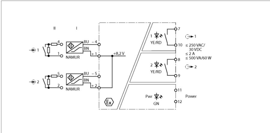
L'amplificateur séparateur à 2 canaux du type IM1-22EX-R est équipé de circuits d'entrée à sécurité intrinsèque.
