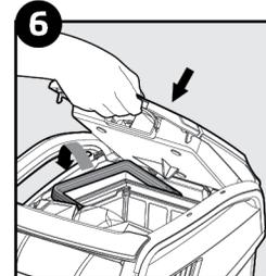
Insérez le panier filtre propre et fermez le couvercle.
