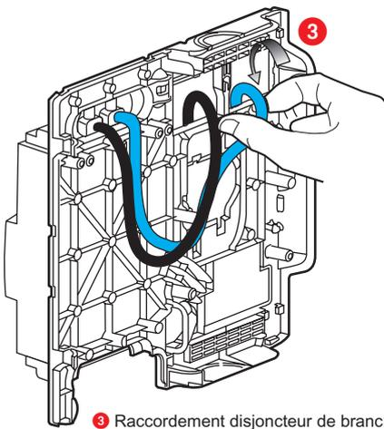
3 Raccordement disjoncteur de branchement - compteur
