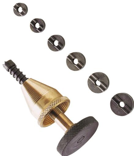
Appareil à fraiser les sièges de robinets. Ressort pour maintenir la fraise au contact du siège de robinet. Fraise taillée en bout, vissée sur le porte-fraise.
