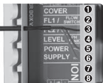
Detector sonda cloro FL2 (rotámetro) 3 negro 5 marrón 6 azul
