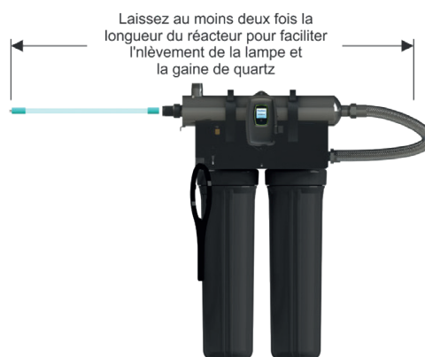
Figure 3. Espace requis pour enlèvement de la lampe
