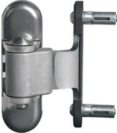
Charnière pour porte aluminium ou métal en acier inoxydable équipée avec le système de fixation Quick-Fix. La charnière est réglable sur 3 dimensions: hauteur, alignement gauche et droit, sens d'ouverture. Aussi disponible avec un bras en acier galvanisé à chaud.
