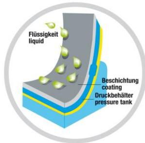
Le pulvérisateur haute performance 405 T dispose d'un réservoir de pression en acier avec un revêtement intérieur en plastique de haute qualité qui peut contenir 5 litres de produit de pulvérisation et qui est approprié à une pression de travail maximale de 6 bars.
