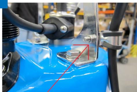
(La vis originale de fixation de l'entrée de câble doit être ré-utilisée pour fixer le clip de réglage)
