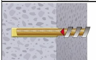
7. Insérez la tige d'ancrage tout en tournant légèrement vers le haut jusqu'au repère d'ancrage.
