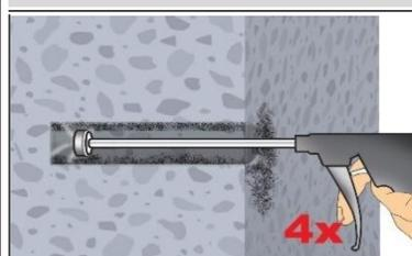
**Attention ! L'eau stagnante dans le trou de perçage doit être retirée avant le nettoyage.**
