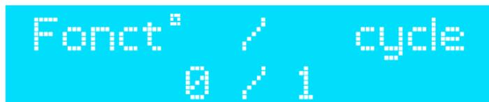
Il est possible via cet écran de visualiser le temps moyen de fonctionnement de l'appareil, ainsi que le nombre de cycle (d'inversion de polarité) effectué.
