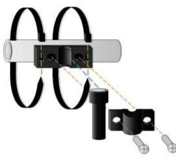
**IT** - Questo accessorio professionale per Taurus, Flotec e Supertec consente di fissare l'interruttore galleggiante a qualsiasi tipo di tubo. Preservando il cavo dal deterioramento che spesso si manifesta nel punto di fissaggio a causa dello stress causato del peso considerevole del galleggiante, il Fixing Kit è anche una semplice soluzione per ridurre il rischio di allagamenti di garage e seminterrati.
