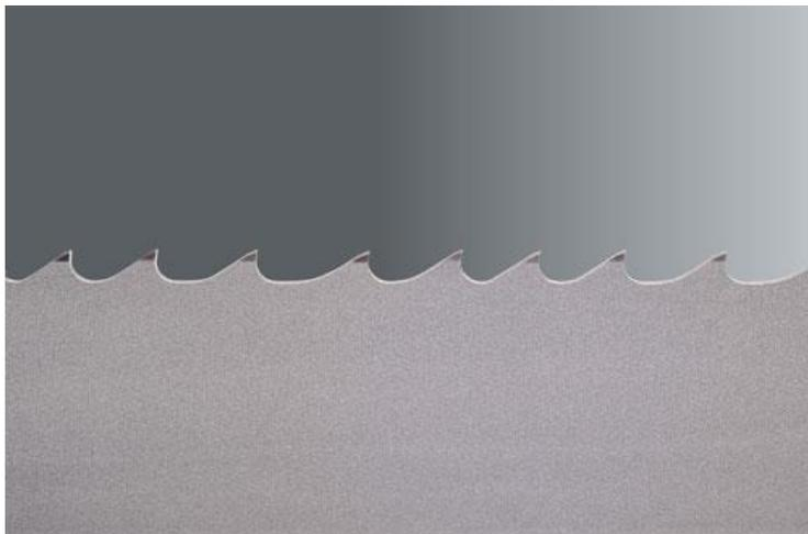
Le ruban duoflex M42 est un ruban bimétal universel. Il se caractérise par sa parfaite résistance à l'usure et sa haute longévité. Son corps en feuillard laminé par Eberle lui procure souplesse et résistance. Ses dents sont composées d'un filin HSS dédié à la coupe de métaux résistants jusqu'à 44Hrc. Permet de découper toutes sortes d'acier, aussi bien en atelier qu'en série de production.
