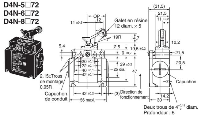
**Levier à galet réglable, verrouillable (levier métallique, galet en résine)**
