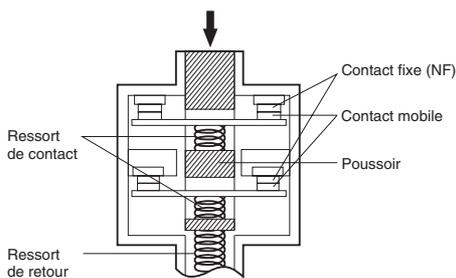
Conforme à la norme EN 60947-5-1 relative à l'ouverture directe ⊖
