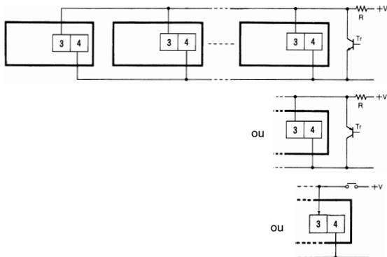
**Note :** le niveau H (Reset ON) doit être de 4,5 V minimum.
