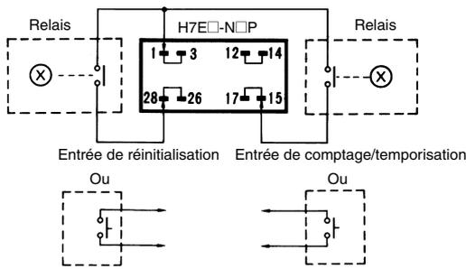
Lorsque vous utilisez le H7EC-NP, il peut arriver que les vibrations du relais soient comptées. Utilisez le H7EC-NLP, l'un des modèles à entrée faible vitesse.
