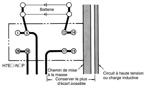
Prendre garde à ne pas appliquer des tensions supérieures aux valeurs suivantes aux bornes de compteur, de minuterie ou de réinitialisation, sinon le circuit interne peut être endommagé.
