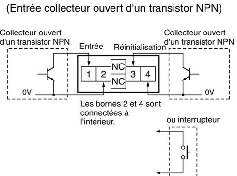
**Note : 1.** La tension résiduelle dans la section sortie des détecteurs de proximité ou photoélectriques devient inférieure à 0,5 V car le courant aux bornes 1 ou 3 est faible (env.  $10 \mu A$ ), ce qui facilite la connexion.
