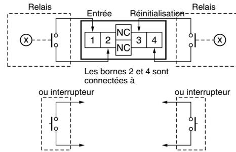
**Note :** utilisez des relais et des interrupteurs à contact de haute fiabilité car le courant aux bornes 1 ou 3 est faible (env.  $10 \mu A$ ). Nous vous recommandons d'utiliser le relais statique G3TA-IA/ID OMRON.
