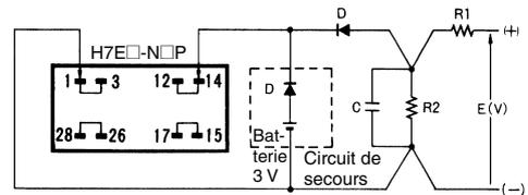
Utilisez une diode (D) possédant une tension avant aussi faible que possible (0,1 V max. à I<sub>F</sub> de 20 μA).
