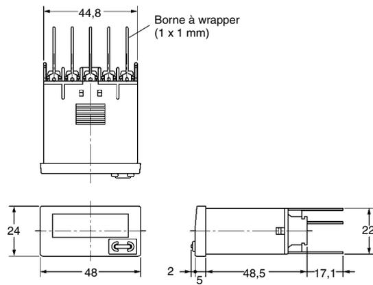
En cas d'utilisation d'une borne à wrapper, s'assurer d'utiliser les câbles et les périphériques corrects. (Les câbles, bits et manchons corrects sont indiqués dans le tableau à droite.)
