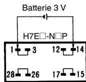
Lors de la conception d'un circuit, utilisez des connexions de câble de puissance d'une longueur inférieure à 50 mm. Pour connaître la polarité de câblage correcte, reportez-vous au schéma de connexion ci-après.
