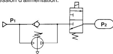
Initialement, la pression d'entrée (**P1**) traverse le clapet anti-retour, remplit **P2**, résultant en **P1 = P2**.
