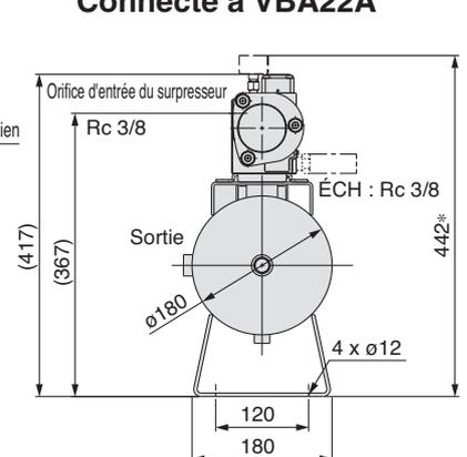
\* La longueur peut être supérieure aux spécifications si les bouchons montés de deux cotés du réservoir ne sont pas raccordés à l'extrémité. Le taraudage de type G est 6 mm plus long en raison des différences de connexion.)
