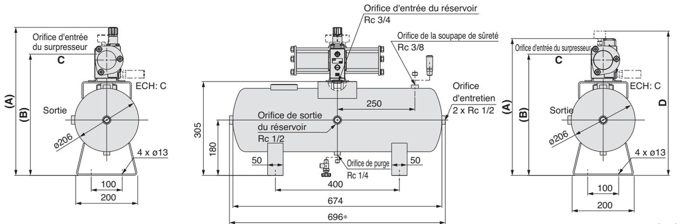
\* La longueur peut être supérieure aux spécifications si les bouchons montés de deux cotés du réservoir ne sont pas raccordés à l'extrémité.
