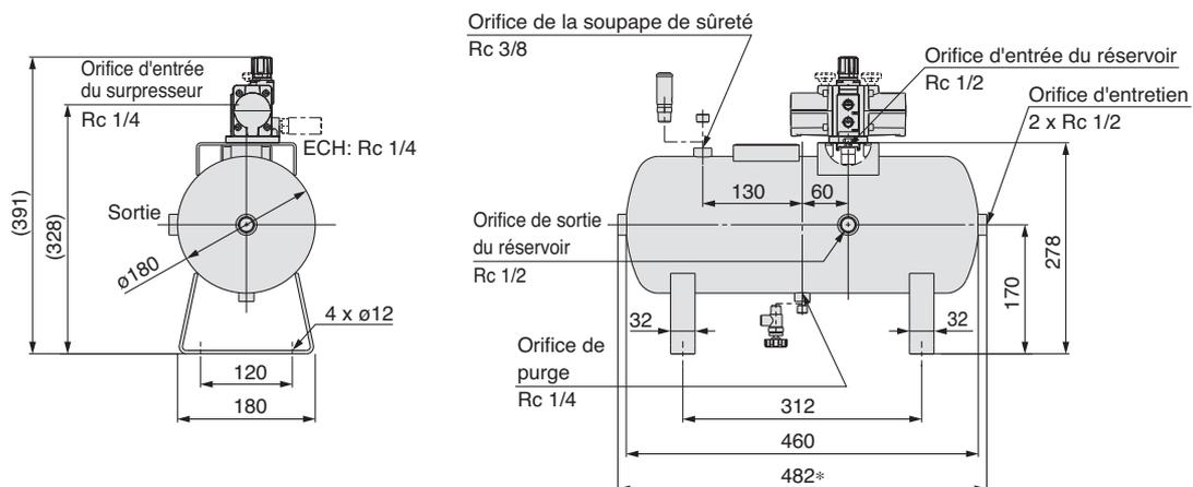
\* La longueur peut être supérieure aux spécifications si les bouchons montés de deux cotés du réservoir ne sont pas raccordés à l'extrémité. Le taraudage de type G est 6 mm plus long en raison des différences de connexion.)
