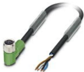
Câbles pour capteurs/actionneurs, 4-pôles, PUR exempt d'halogène, gris-noir RAL 7021, extrémité libre, sur Connecteur femelle coudé M8, longueur de câble: 5 m
