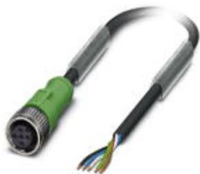
Câbles pour capteurs/actionneurs, 5-pôles, PUR exempt d'halogène, gris-noir RAL 7021, extrémité libre, sur Connecteur femelle droite M12, détrompage A, longueur de câble: 10 m
