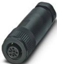
Connecteur, Universel, 5-pôles, Connecteur femelle droite M12, Raccordement vissé, matériau de la molette: Plastique, presse-étoupe Pg7, diamètre extérieur du câble 4 mm ... 6 mm
