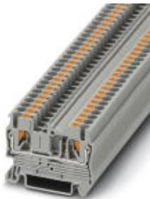
Blocs de jonction simple, tension nominale: 800 V, intensité nominale: 24 A, type de raccordement: Raccordement Push-in, nombre de connexions: 2, nombre de pôles: 1, section : 0,14 mm<sup>2</sup> - 4 mm<sup>2</sup>, AWG: 26 - 12, largeur: 5,2 mm, hauteur: 35,3 mm, coloris: gris, type de montage: NS 35/7,5, NS 35/15
