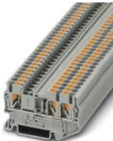
Blocs de jonction simple, tension nominale: 800 V, intensité nominale: 24 A, type de raccordement: Raccordement Push-in, nombre de connexions: 3, section : 0,14 mm<sup>2</sup> - 4 mm<sup>2</sup>, AWG: 26 - 12, largeur: 5,2 mm, hauteur: 35,2 mm, coloris: gris, type de montage: NS 35/7,5, NS 35/15
