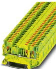
Bloc de jonction pour conducteur de protection, type de raccordement: Raccordement Push-in, nombre de connexions: 3, section : 0,14 mm<sup>2</sup> - 4 mm<sup>2</sup>, AWG: 26 - 12, largeur: 5,2 mm, hauteur: 35,2 mm, coloris: vert/jaune, type de montage: NS 35/7,5, NS 35/15
