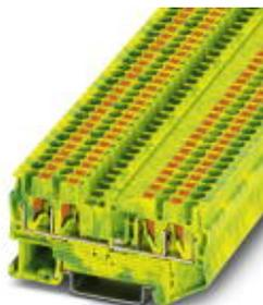
Bloc de jonction pour conducteur de protection, type de raccordement: Raccordement Push-in, nombre de connexions: 4, section : 0,14 mm<sup>2</sup> - 4 mm<sup>2</sup>, AWG: 26 - 12, largeur: 5,2 mm, hauteur: 35,3 mm, coloris: vert/jaune, type de montage: NS 35/7,5, NS 35/15
