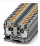
Blocs de jonction simple, tension nominale: 1000 V, intensité nominale: 57 A, type de raccordement: Raccordement Push-in, Raccordement Push-in, nombre de connexions: 2, section : 0,5 mm² - 16 mm², AWG: 20 - 6, largeur: 10,2 mm, hauteur: 49,5 mm, coloris: gris, type de montage: NS 35/7,5, NS 35/15
