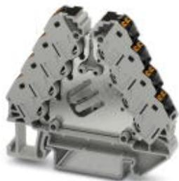
Distributeurs de potentiel, tension nominale: 250 V, intensité nominale: 17,5 A, section : 0,14 mm<sup>2</sup> - 2,5 mm<sup>2</sup>, AWG: 14 - 26, type de raccordement: Raccordement Push-in, nombre de pôles: 2, nombre de connexions: 16, largeur: 8,3 mm, longueur: 64 mm, coloris: gris, couleur des éléments de raccordement: noir, montage: NS 35/7,5, NS 35/15
