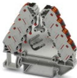
Distributeurs de potentiel, tension nominale: 250 V, intensité nominale: 17,5 A, section : 0,14 mm<sup>2</sup> - 2,5 mm<sup>2</sup>, AWG: 14 - 26, type de raccordement: Raccordement Push-in, nombre de pôles: 2, nombre de connexions: 16, largeur: 8,3 mm, longueur: 64 mm, coloris: gris, couleur des éléments de raccordement: rouge, montage: NS 35/7,5, NS 35/15
