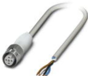
Câbles pour capteurs/actionneurs, 4-pôles, PP-EPDM exempt d'halogène, gris RAL 7035, extrémité libre, sur Connecteur femelle droite M12, détrompage A, longueur de câble: 5 m, Conception hygiénique, avec molette inox
