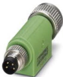
Adaptateur, 4-pôles, Connecteur droite M8, détrompage A, sur Connecteur femelle droite M12, détrompage A
