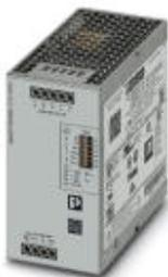
Alimentation QUINT POWER à découpage primaire, avec caractéristiques de sortie au choix, technologie SFB (Selective Fuse Breaking) et interface NFC, entrée : triphasée, sortie : 24 V DC / 20 A
