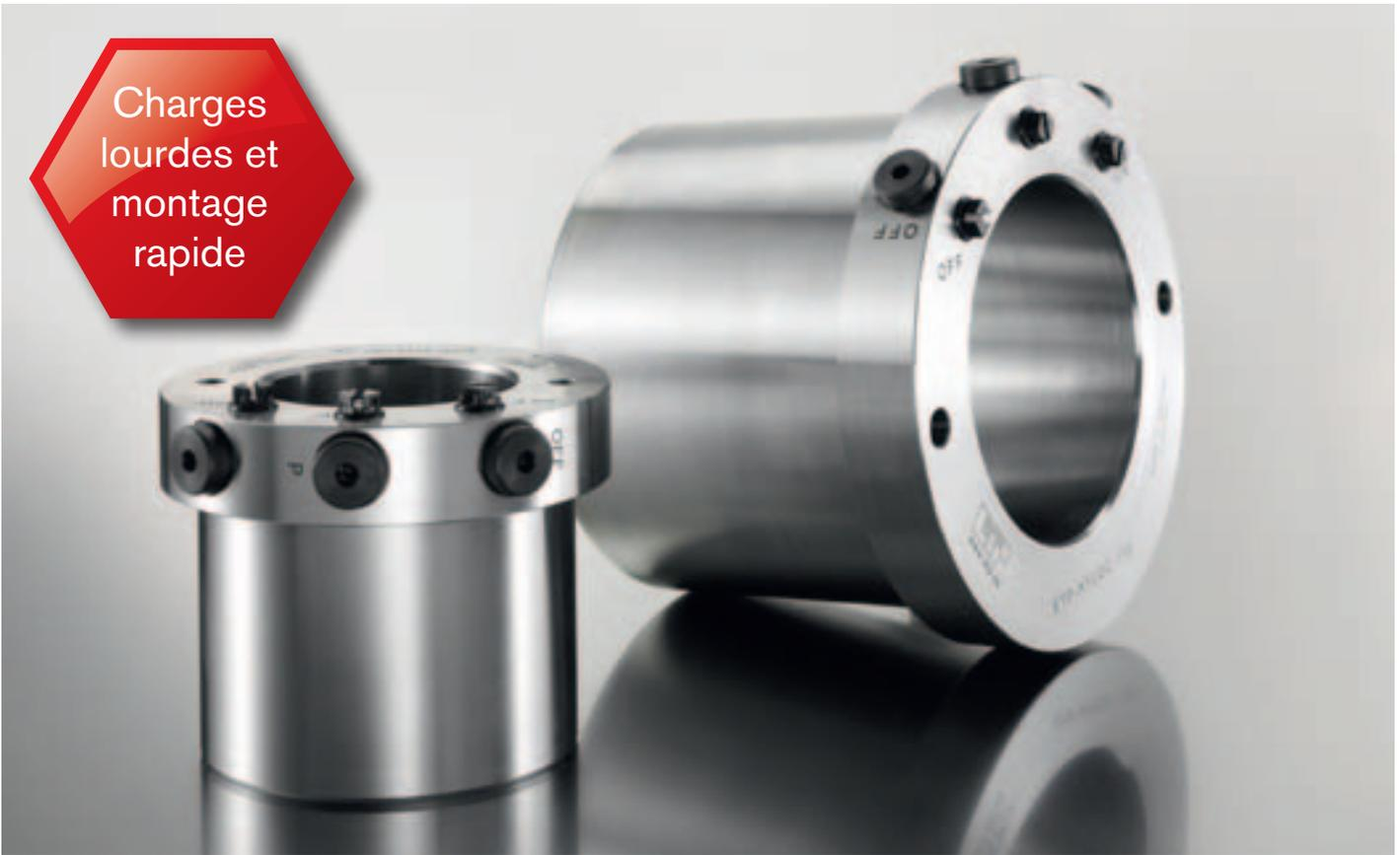
ETP-HYLOC est disponible en standard pour les arbres de 50 à 220mm. Concentricité 0.02 mm Nombre de montages : Max. 2000. Fabrication spéciale pour arbre > 220mm sur demande. Pour application à fort couple, la surface de contact de ETP-HYLOC (tailles  $\geq 100$ mm) peut être traitée ETP-HFC, revêtement haute friction qui double la capacité de couple.
