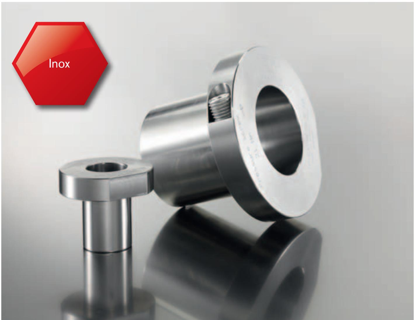
ETP-EXPRESS R est disponible en standard pour les arbres de 15 à 80. Concentricité  $\leq 0.02\text{mm}$  Nombre de montages 200 à 800 (Selon la taille). Le faible dimensionnel permet un montage compact, un faible poids et une faible inertie.
