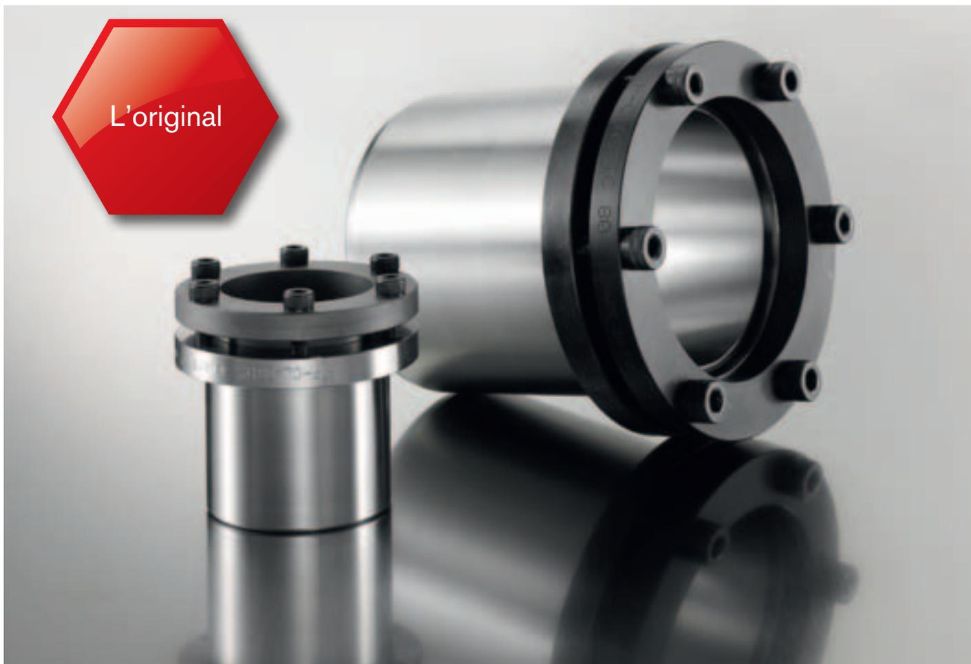
ETP-CLASSIC est disponible en standard pour les arbres de 15 à 100mm également disponible en version courte (type S) et en inox (type R). Concentricité 0.03-0.06mm Nombre de montages 100 (type R=50) Le peu de vis de serrage à faible couple de serrage rend la procédure de montage/démontage rapide et facile.
