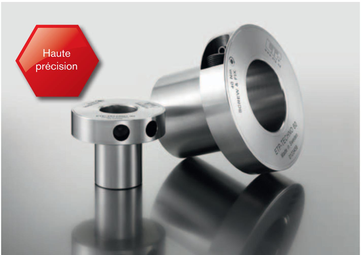
ETP-TECHNO est une bague de serrage hydraulique de haute précision pour des montages fréquents. Disponible en standard pour les arbres de 15 à 130mm. Concentricité  $\leq 0.006\text{mm}$  Nombre de montages 500 à 5000 (Selon la taille). Elle a une étanchéité supplémentaire réalisée à l'aide d'une bille d'acier au bout du piston qui appuie sur un logement sphérique quand le piston est actionné. ETP-TECHNO est souvent utilisé comme base pour les applications spéciales.
