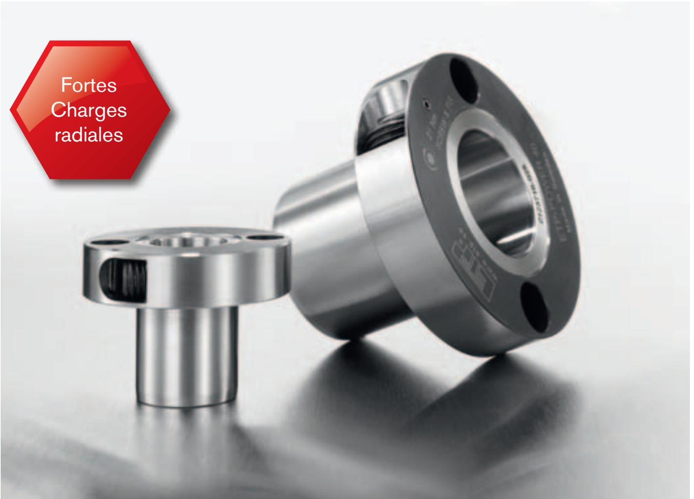
ETP-POWER est disponible en standard pour les arbres de 15 à 40mm. Concentricité  $\leq 0.03\text{mm}$  Nombre de montages 200 à 500 (Selon la taille). ETP-POWER combine le montage rapide et la forte capacité à reprendre les charges radiales grâce aux propriétés spécifiques du fluide
