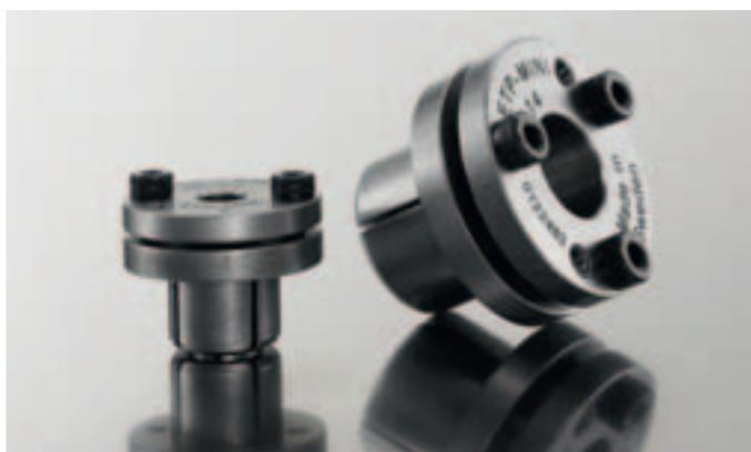
ETP-MINI est disponible en standard pour les arbres de 6 à 14mm. Concentricité 0.02 mm Nombre de montages 100 (Inox type R=50). ETP-MINI est l'une des bagues de serrage mécanique les plus compactes du marché pour vous permettre d'optimiser vos conceptions.
