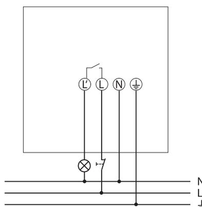
L'appareil peut être activé manuellement à l'aide d'un bouton-poussoir d'interruption. Une fois que le bouton-poussoir a été relâché (retour de la tension), l'appareil s'enclenche (pour au moins 40 s ou pour la durée définie pour l'appareil).
