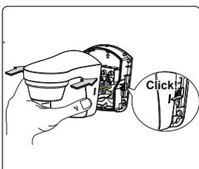
➤ Enfiler le détecteur de mouvement sur le socle et l'enclencher.
