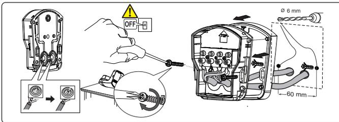
➤ Faire passer le câble à travers le joint d'étanchéité du socle.
