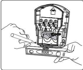
➤ Reporter les marquages pour les trous au mur (avec le gabarit de perçage fourni/socle).
